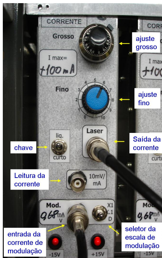
Figura 3.13: Detalhe do controle de corrente.
