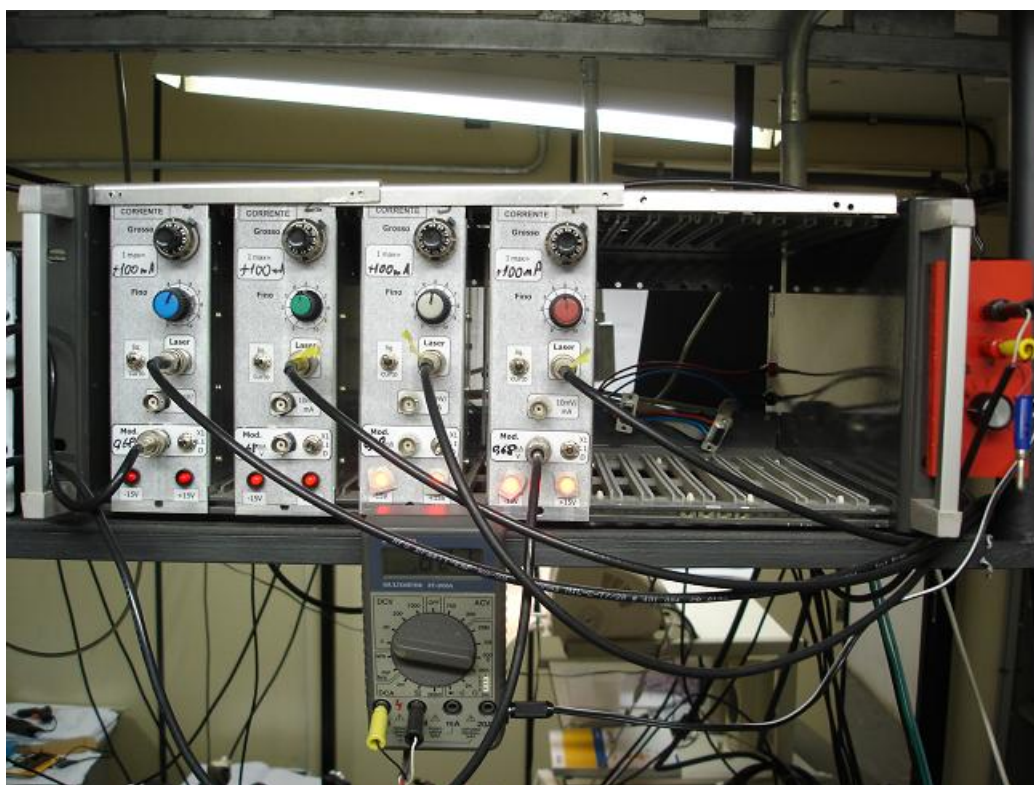
Figura 3.12: Controle de corrente dos lasers.
