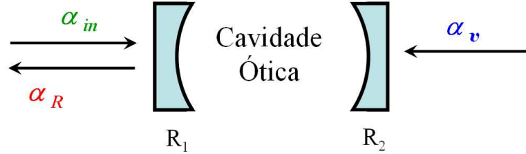
Figura 1.4: Esquema de cavidade ótica composta por espelhos com coeficiente de reflexão de intensidade R_1 e R_2 . O campo incidente é denotado por \alpha_{in} , o refletido por \alpha_R e o vácuo que entra pelo segundo espelho por \alpha_v .
